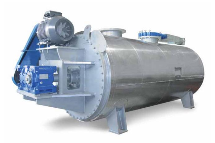
L'autoclave discontinua CBD di P.C.M. è composta da un involucro cilindrico ad asse orizzontale costruito in lamiera di acciaio al carbonio di grosso spessore, portante una camicia di riscaldamento a circolazione di vapore.
