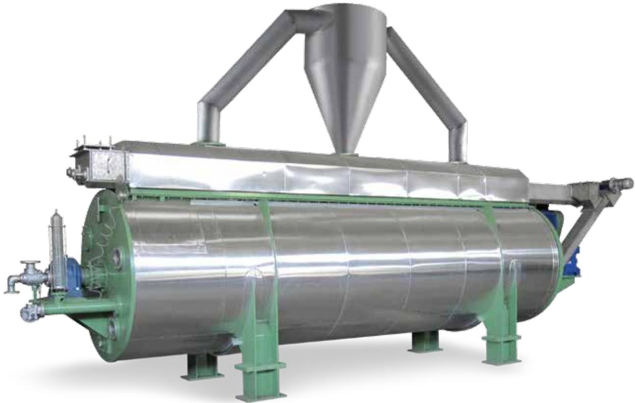
L'autoclave continua CBC è dotata di un sistema che, sfruttando le calorie prodotte dalle fumane in uscita, effettua un preriscaldamento del materiale prima della sua immersione nel corpo centrale della macchina.
