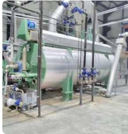
Il cuocitore è premontato su di un basamento in profilati di acciaio elettrosaldato. L'autoclave è coibentata con lana di roccia sp.60mm., rivestita con lamierino di alluminio dello spessore di 8/10 fissato mediante viti autofilettanti. La fornitura comprende n.1 sonda PT100, manometro e termometro analogico, n.4 celle di carico a bordo macchina.
