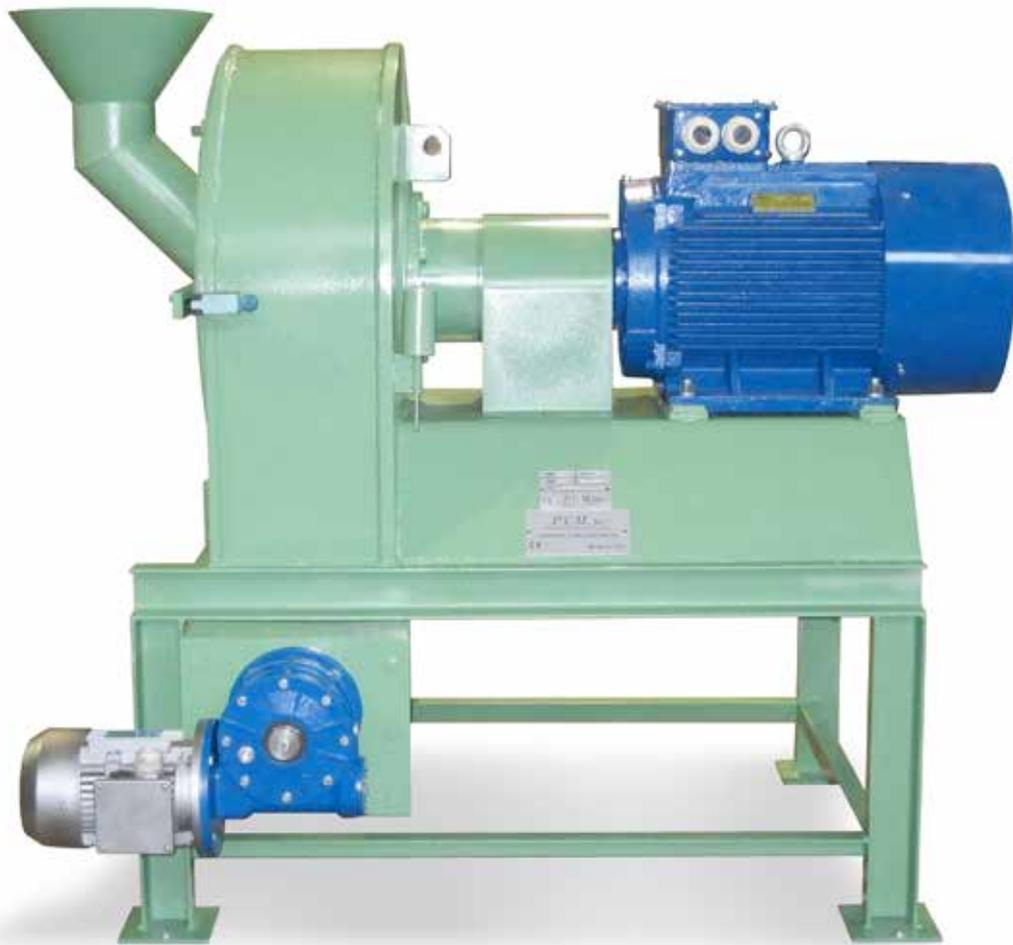
Il mulino a martelli di P.C.M. è costituito da una solida e robusta struttura in ferro verniciato.
