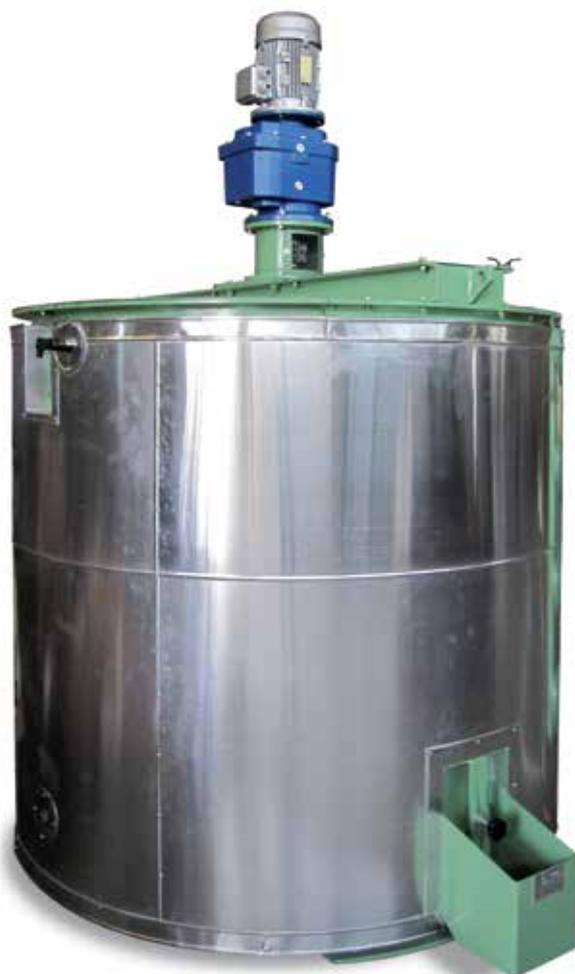
La P.C.M. progetta e costruisce preriscaldatori per il trattamento dei semi oleosi prima della loro pressatura e conseguente estrazione dell'olio.
